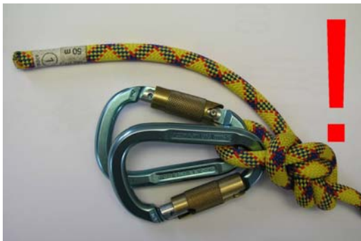
Abbildung 14: der Achterknoten ist teilweise geöffnet
