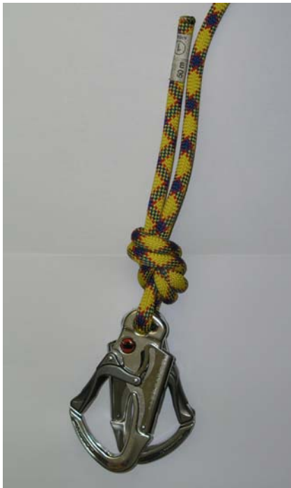
Abbildung 7: Aufbau mit zwei Klettersteigkarabinern der Attack-Bauweise
