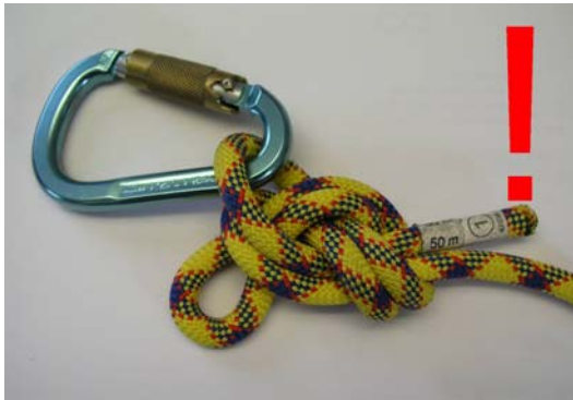
Abbildung 15: Karabiner wird in teilweise aufgezogenen Achter eingehängt.
