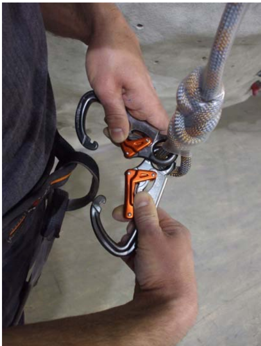
Abbildung 5: gegengleiches Einhängen der Karabiner zum Anseilen
