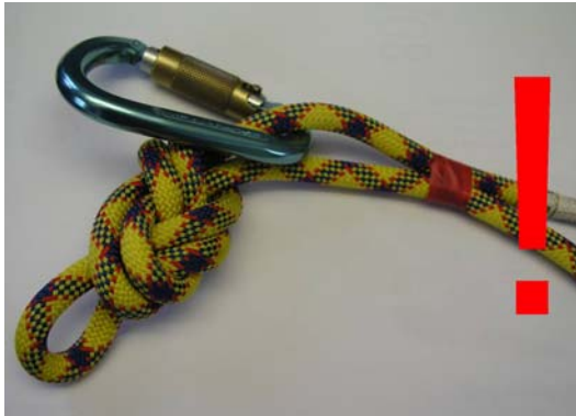
Abbildung 13: Klebeband zur Fixierung des Restseils
